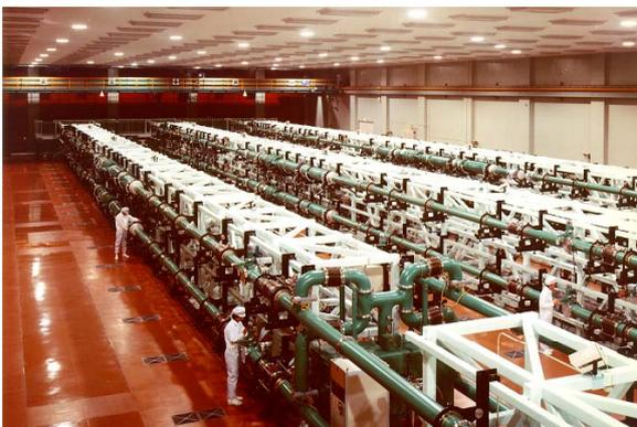
レーザー核融合実験用のレーザー増幅器
