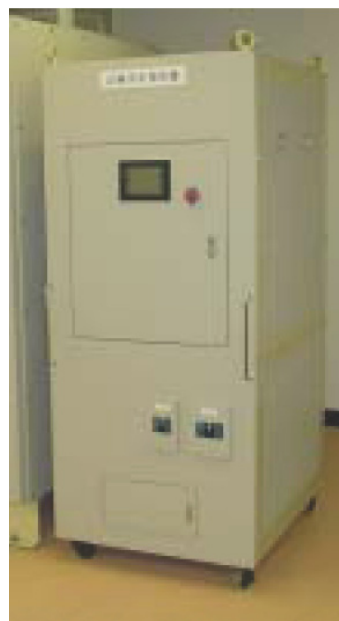
図2 SiCインバータ装置 (800W × 1000D × 1800H)
