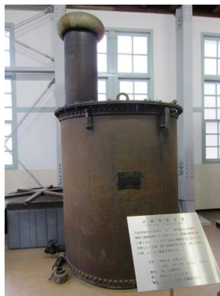
図5 250kV試験用変圧器
