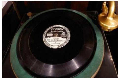
図2:永久型ダイヤモンド針、垂直記録80rpm、径250mm、厚さ約5mmである。(エジソンの演説が録音)
