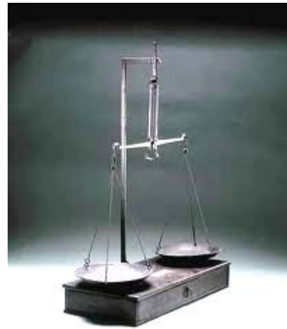
図 2 ブラックの等比天秤(18 世紀当時の化学実験の基本機器) スコットランド博物館蔵
