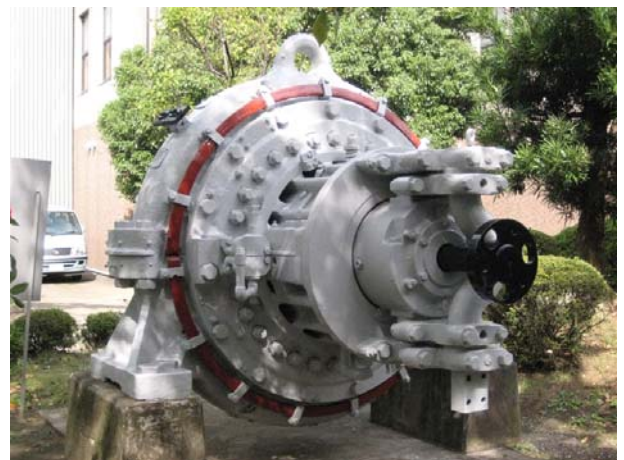
125kVA アレキサンダーソン高周波発電機 (株)東芝 京浜事業所所蔵
