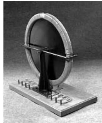
テスラの二相交流モータ(ドイツ博物館所蔵貸与展示品)
