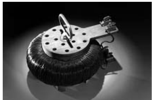
ガンツ社の変圧器（ハンガリー電気技術博物館所蔵賞与展示品）
