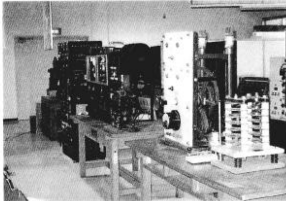
左奥から船舶用短波送信機、初期の真空管式長中波送信機、テスラコイルと放電電機
