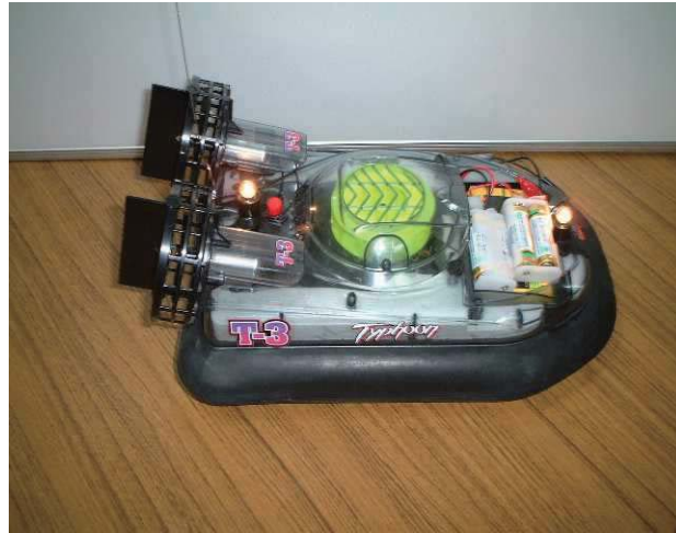
ホバークラフト模型：全長 356 [mm], 全幅 212 [mm], 全高 142 [mm], 質量 0.894 [kg]
