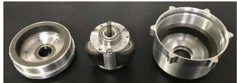
減速機の内部
