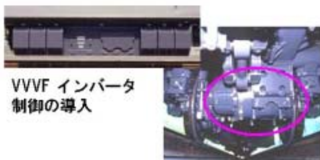
小型軽量の誘導電動機の採用
