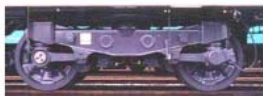
台車構造の見直し →ボルスタレス+軸梁式軸箱支持
