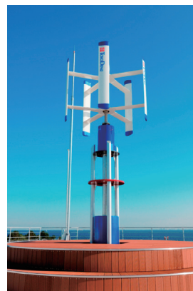
図3 実証試験で用いる直線翼垂直軸風車
