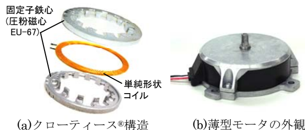
図2 圧粉磁心を適用した薄型モータ
