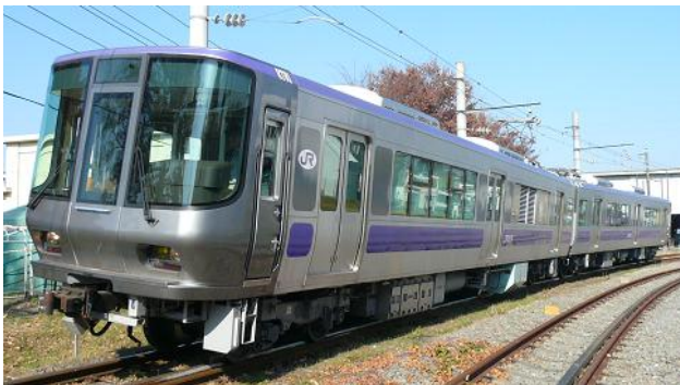
図1 R291系 燃料電池・バッテリーハイブリッド試験電車
