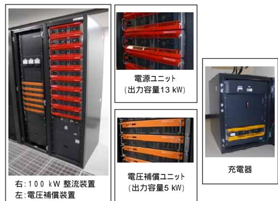
図3. 試作した整流装置・電圧補償装置・充電器の外観
