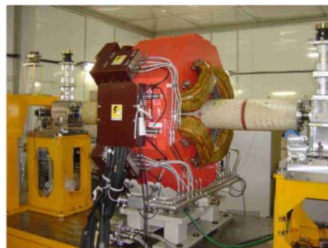
図 2 磁場測定中の四極電磁石
