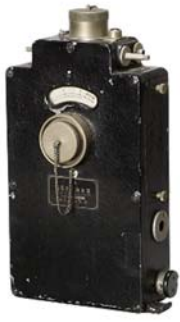
理研光干渉計式ガス検定器3型(左)と装置構造・測定原理(右)
