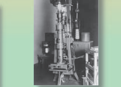
でん し けん ひきょうえつしゆー に かに 電子顕微鏡 HU-2 型 (透過型電子顕微鏡) Model HU-2 Electron Microscope
