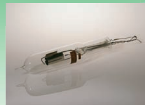
おかべきんじろうとぶんかつようき 岡部金治郎と分割陽極マグネトロン Kinjiro Okabe and Split-Anode Magnetron
