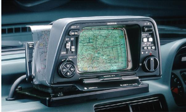
かつて知らない土地へのドライブは、地図を見てはおおよその経路を確認しながら運転し、交差点でまた地図を確認する、もしくは助手席にいる人に地図で方向を確認してもらう、などの繰り返しで、危険であるばかりか非常に不便であり、疲労感が増すと共に燃料や時間的なロスをも伴うのが一般的でした。このため、飛行機や船舶に搭載されていた「慣性航法装置」を自動車に搭載して道案内し、このような不便やロスを軽減できないかという夢がありました。この夢を実現したのが、地図を備えた自動車用慣性航法装置、つまり「地図型自動車用ナビゲーションシステム」であり、本田技研工業株式会社（ホンダ）が1981年（昭和56年）に世界で初めて完成させ、「ホンダ・エレクトロ・ジャイロケータ」として発売したものです。
