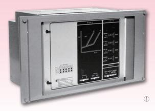
電気は、現代社会に欠くことのできない社会基盤です。電気は発電所で発電され工場や皆さんの家庭に送られて、モーターを回したり電灯を点けたりします。ここで、電気を送るために送電線や変電所などの設備がありますが、落雷や風雪の影響、樹木の接触などでこれらの設備に事故が起こることがあり、これを素早く検出し除去しなければ停電になり、色々な支障が出てしまいます。このため保護リレーという装置が設けられており、数十ミリ秒という短時間で事故を検出し、大きな電流が流れても電気を切ることができる、電力用の遮断器に事故を除去するための指令信号を出して停電を防ぐ働きをしています。
