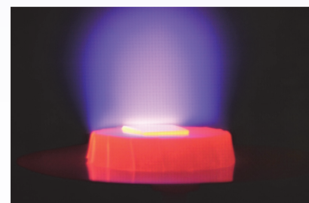
プラズマCVDによるダイヤモンド成膜
